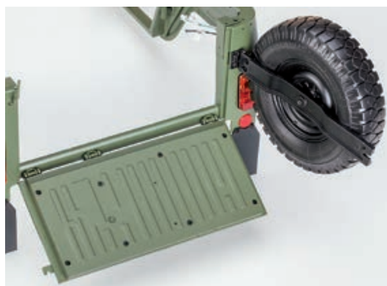
Шаг 3. Для облегчения монтажа ограничителей заднего борта модели снимите кронштейн держателя запасного колеса.
