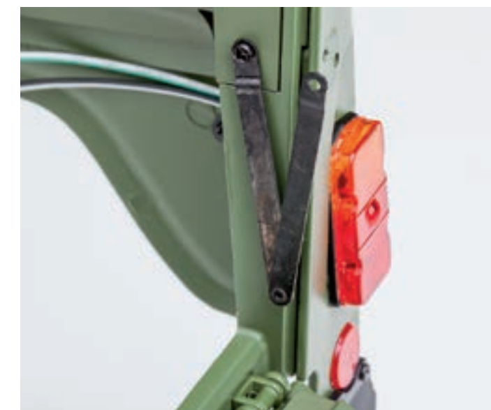
Шаг 4. Установите ограничитель заднего борта в проем откидного борта кузова около заднего правого крыла. Обратите внимание: на кузове необходимо закрепить более длинный элемент ограничителя. Для фиксации детали используйте винт 1,7×3 (КР).
