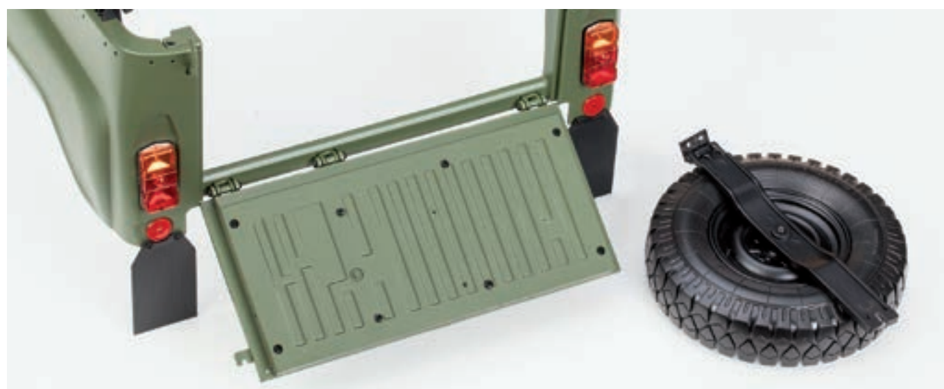
Шаг 3. Для облегчения монтажа ограничителей заднего борта модели снимите кронштейн держателя запасного колеса.
