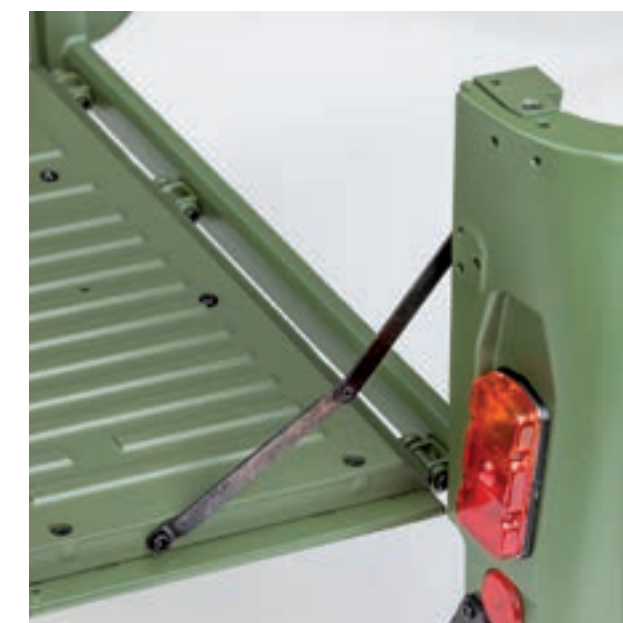
Шаг 5. Зафиксируйте свободную планку ограничителя в торце откидного борта кузова при помощи винта 1,7×3 (КР). По окончании монтажа детали ограничителя должны оставаться подвижными.
