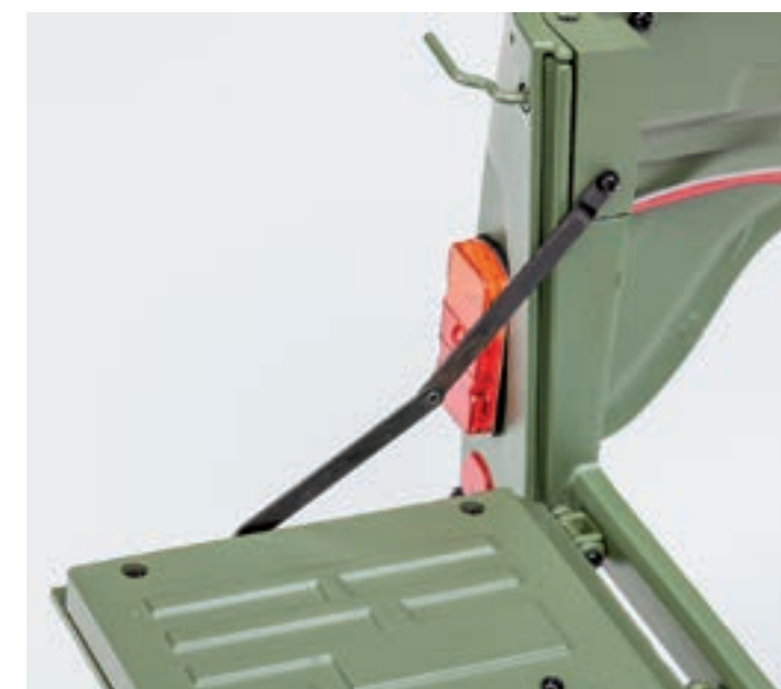
Шаг 4. Установите ограничитель заднего борта в проем откидного борта кузова около заднего правого крыла. Обратите внимание: на кузове необходимо закрепить более длинный элемент ограничителя. Для фиксации детали используйте винт 1,7×3 (КР).
