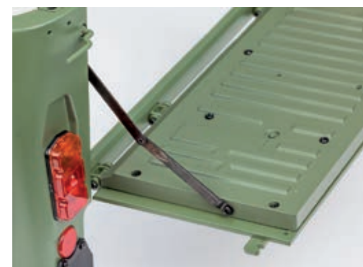
Шаг 5. Зафиксируйте свободную планку ограничителя в торце откидного борта кузова при помощи винта 1,7×3 (КР). По окончании монтажа детали ограничителя должны оставаться подвижными.
