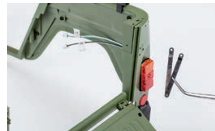
Шаг 4. Установите ограничитель заднего борта в проем откидного борта кузова около заднего правого крыла. Обратите внимание: на кузове необходимо закрепить более длинный элемент ограничителя. Для фиксации детали используйте винт 1,7×3 (КР).
