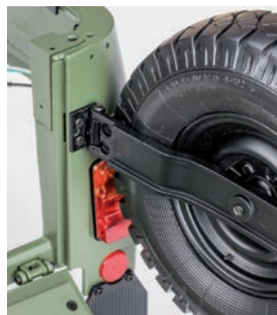
Шаг 3. Для облегчения монтажа ограничителей заднего борта модели снимите кронштейн держателя запасного колеса.
